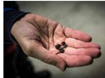
Knust Filtralite HC 2,5-5 anvendt som filter hos VEAS.
