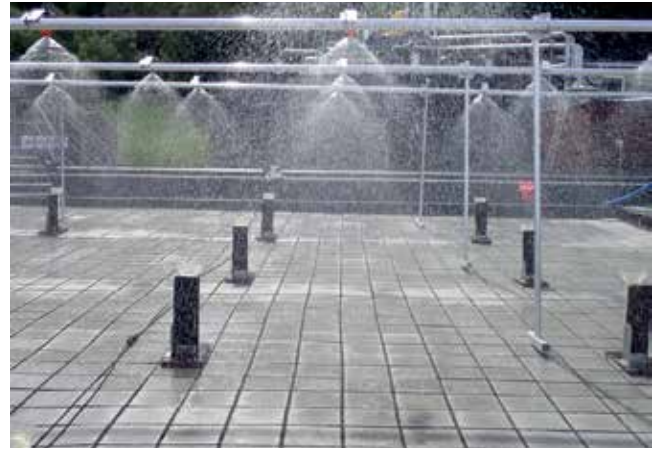
Klima 2050 fokuserer på løsninger med høj vandtilbageholdelse-kapacitet og er i stand til at køre ekstreme tests. Her testes vandtilbageholdelsen i permeabel belægning med et underlag af Leca letklinker. Foto: Tore Kvande, NTNU
